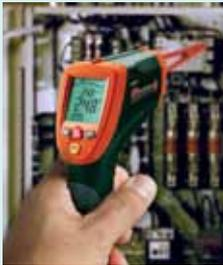
Extechの42570-Jは、最高2,200℃まで計測可能な非接触型赤外線温度計です。高速100msの応答時間で、2つのレーザーがカバーする範囲で高精度なスポット計測が可能です。さらに、Kタイプ熱電対入力による接触温度測定もできるため、幅広いアプリケーションに対応します。付属のソフトウェア、ケーブル、USBインターフェースを使えばPCに連続データが転送できるため、後で温度解析が可能です。
