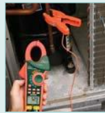
長高熱速のために必要な差動温度測定値を取るためのデュアル Type K 入力
