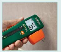
ダイレクト・ピンを用いてシートロック やその他の建材の水分の割合を%で測定します。 写真の保護キャップは使用中を示し ハウジングされます。
