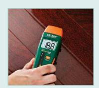
木材、パーティクル・ボードとカーペット、 天井俗室のタイルを含む様々な建材の 相対的な水分を非侵襲ピンレス・テクノ ロジーを使って測定
