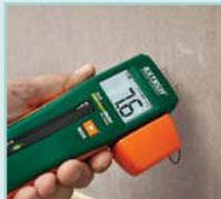
直接ピン方式を使用してシート・ロックやその他の建材の水分の%を測定。保護キャップは使用中はハウジング横に格納
