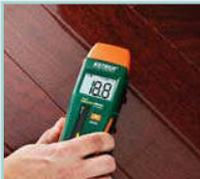
無侵襲ピンレス・テクノロジーを使った木材、パーティクル・ボード、カーペットと天井タイルを含む各種建材の相対水分測定
