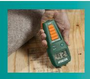
便利なコンパクト・サイズの水分計で木材や建材の水分レベルの 基準測定値を迅速に取ります。水分量のレベルの表示に加えて 可聴警報機能で表示アイコンで簡単操作。床やカーペットの下の 水分検出が重要な建物修復プロジェクト等のアプリケーションの 構築に最適です。壁の後ろや天井の水漏れ後の効果を分析する ための必須ツールです。
