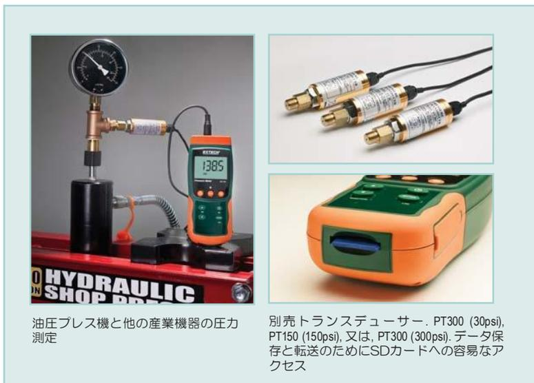
油圧プレス機と他の産業機器の圧力測定
