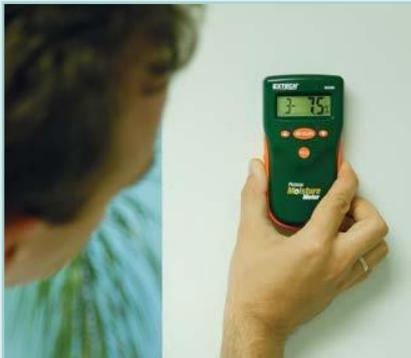
非侵襲的ピンレス・テクノロジーで傷つけることなく壁材の水分を測定
