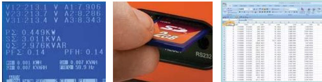
バックライト LCDがニューメリック地を表示。SDメモリー・カード(付属)からログされた測定値をExcelソフトウェアを使用してメーターからPCに転送
